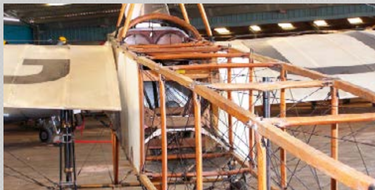
Il telaio di legno del Blériot era tenuto insieme da cavi.
