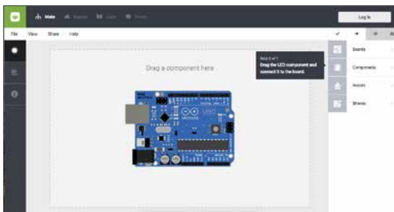
**Figura 1.15** - L'area principale di lavoro di Bitbloq; trascinate una scheda Arduino Uno per iniziare a comporre codice.
